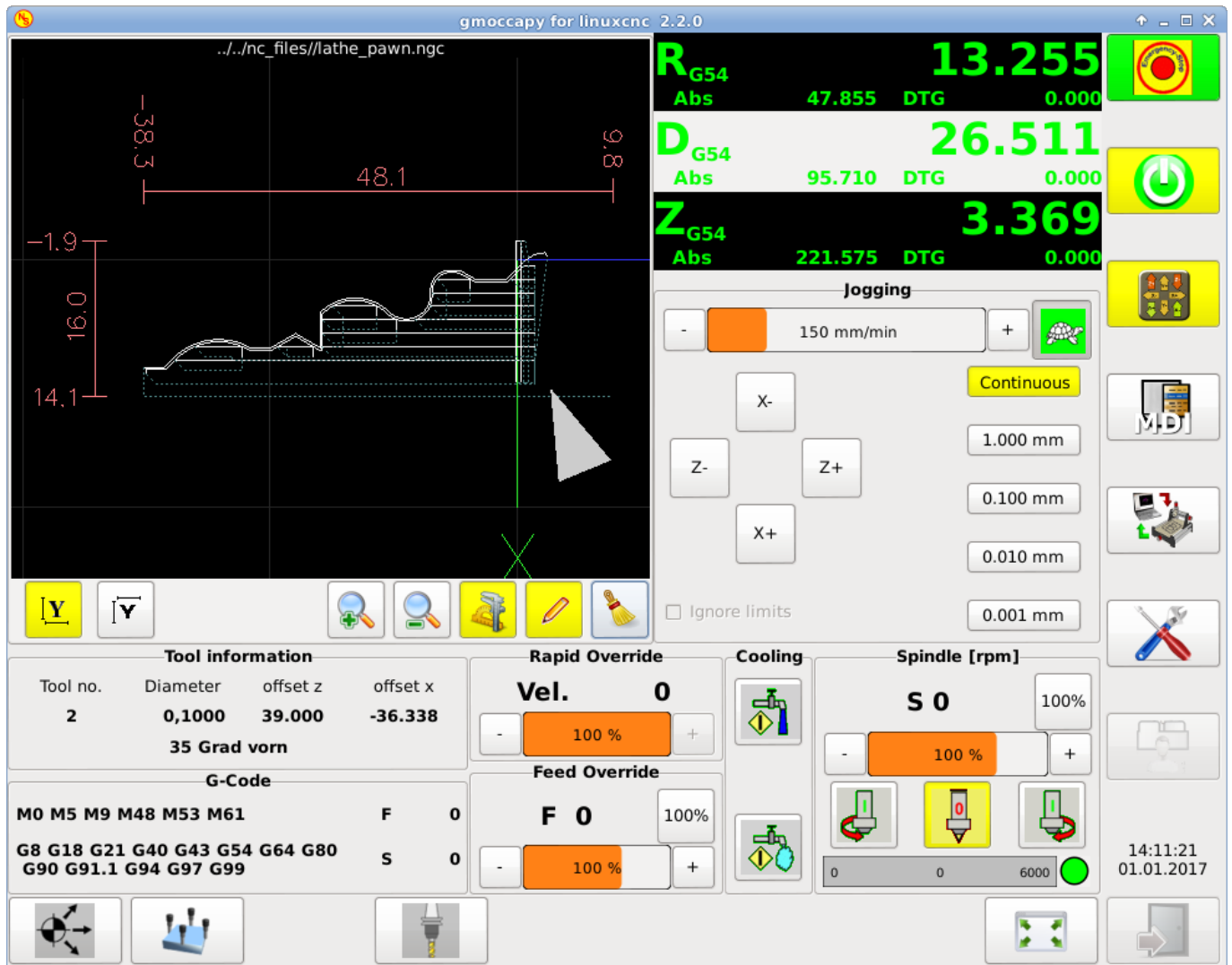
Figura 4.18: Torno normal (herramienta delantera)
